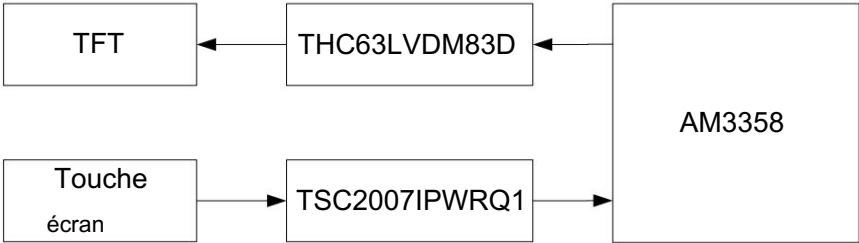
Figure 7-4 Module de fonction d'écran et de commande tactile
