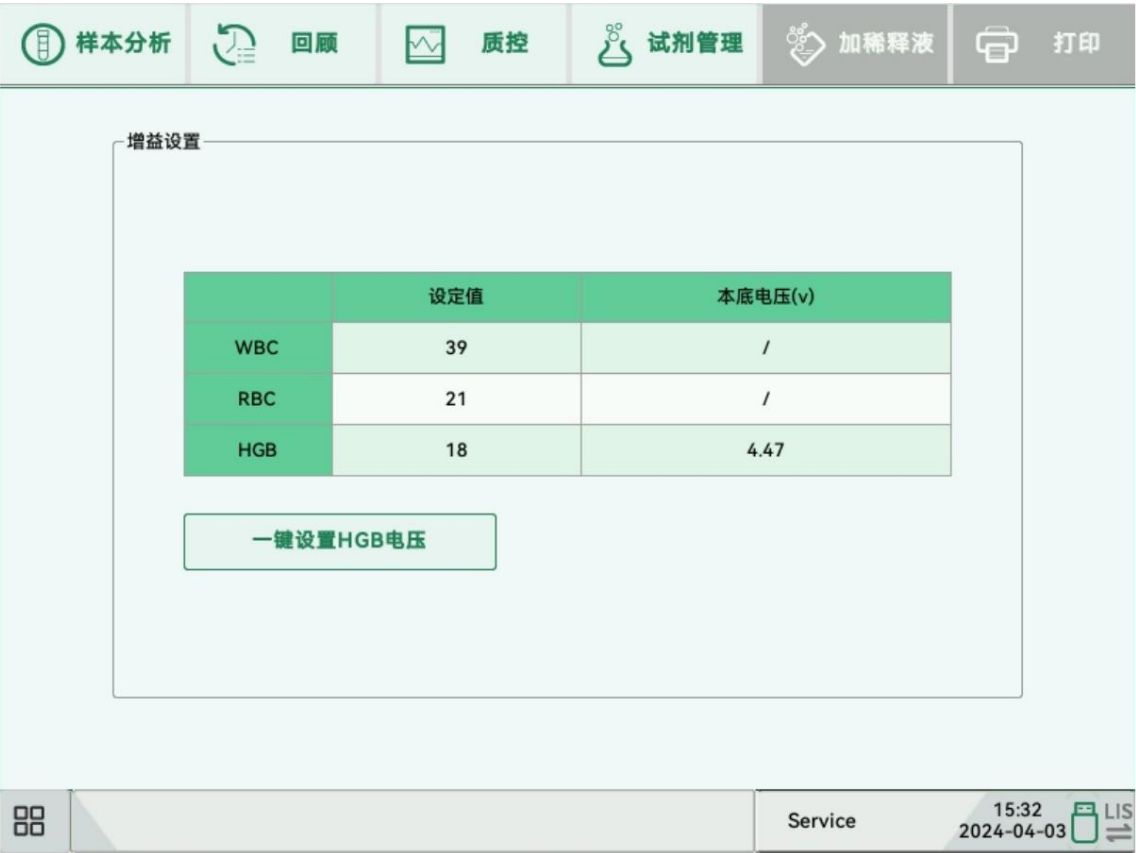
Figure 4-4 Interface de réglage du gain
