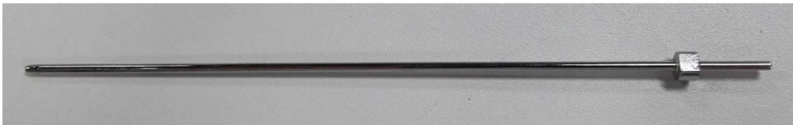
Aiguille de prélèvement ouverte
